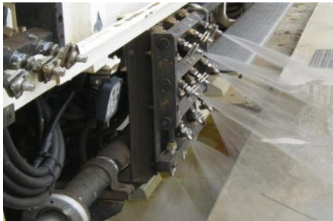
Essai des buses, à l'eau, sur l'aire de lavage étanche
